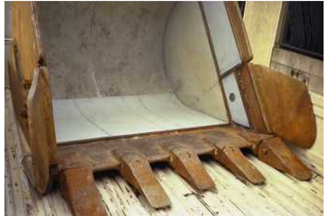
パワーショベル 張替え修理後
