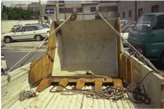
パワーショベル 摩耗修理
