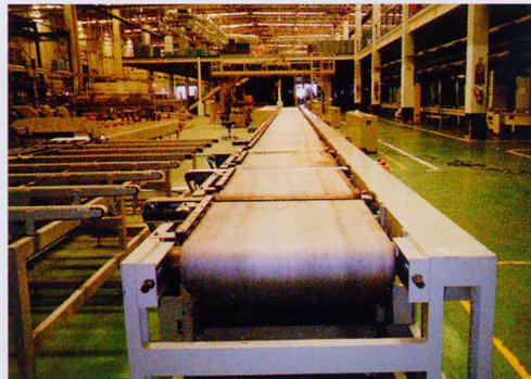
■アルミ押し出し成型ライン耐熱防傷コンベアーベルト 耐熱フェルト+C2H
