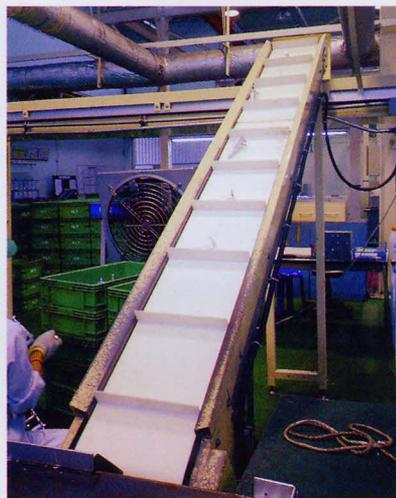
■アルミダイキャスト製造ライン耐熱フェルト貼り傾斜コンベアーベルト 耐熱フェルト+T-2C(プロフィール付)
